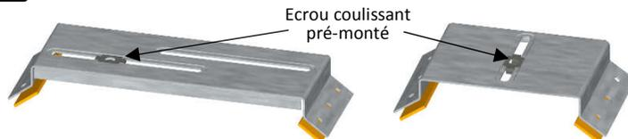
Equiper les platines sur toute leur largeur avec un complément d'étanchéité référencé (joint EPDM, largeur 30mm, épaisseur 3mm) après nettoyage des surfaces de contact.
